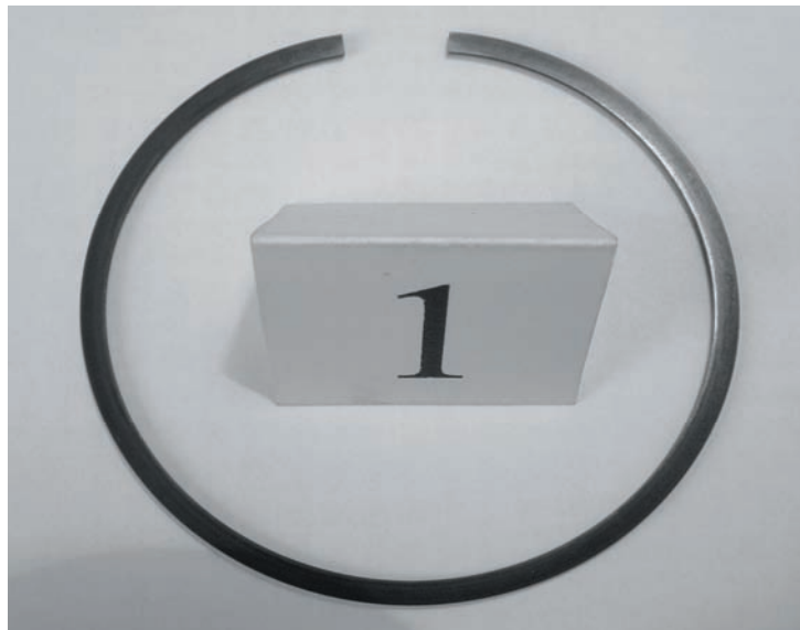
Rys. 4. Widok górnej półki drugiego pierścienia uszczelniającego cylindra nr 1 Fig. 4. The view upper shelf of second sealing ring of the sleeve No. 1
