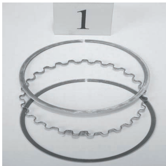
Rys. 8. Widok zgarniającego pierścienia składanego cylindra nr 1 Fig. 8. The view of oil ring of the sleeve No. 1
