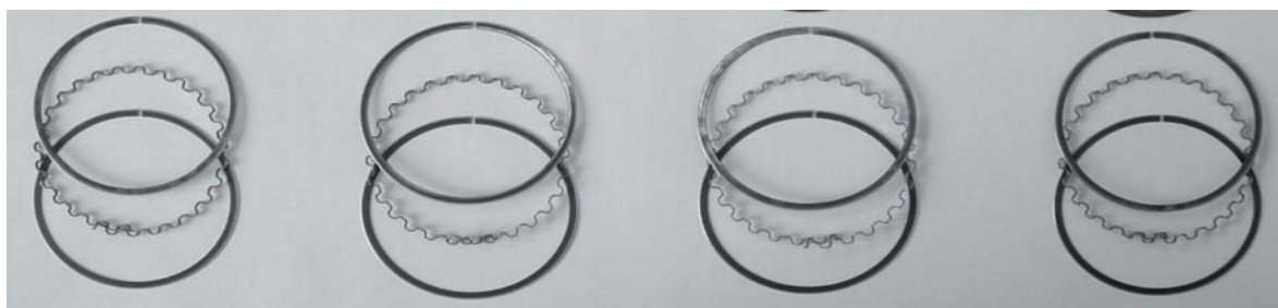
Rys. 7. Widok trzecich zgarniających pierścieni składanych po próbie Fig. 7. The view of oil rings after the durability test
